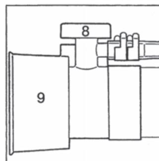
Закрутите измерительную кнопку (8) стандартного выпускного отверстия (9).
