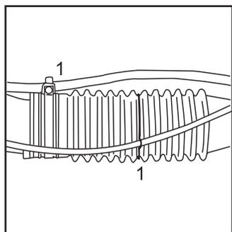
Установите фиксирующий винт (1) и закрепите хомутом гибкий шланг.
