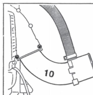
До упора вставьте сборочное колено (10), оснащенное приспособлением, в корпус вентилятора.
