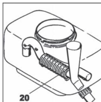
Воронка (20) должна быть установлена на контейнере для лучшего распространения распыляющих веществ. Снимите воронку перед заполнением контейнера гранулированными смесями. Затем установите воронку на контейнер.
