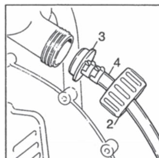
Закрутите соединительную гайку (2), предварительно установив, редуктор (3) со шлангом (4).
