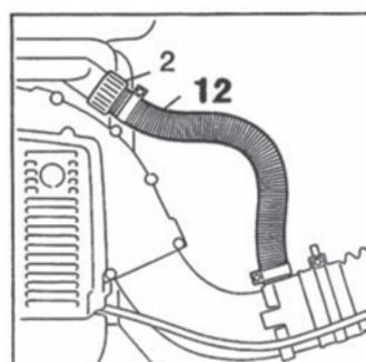
Вставьте ответвление (12) в контейнер. Вставьте соединительную шайку (2) и плотно её затяните.
